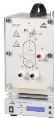
Fig. 1 Heizofen mit Franck-Hertz-Röhre mit Hg-Füllung (115 V: 1006794, 230 V: 1006795)
