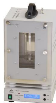
Fig. 2 Heizofen mit Natrium-Resonanzfluoreszenz-Röhre (1000913)
