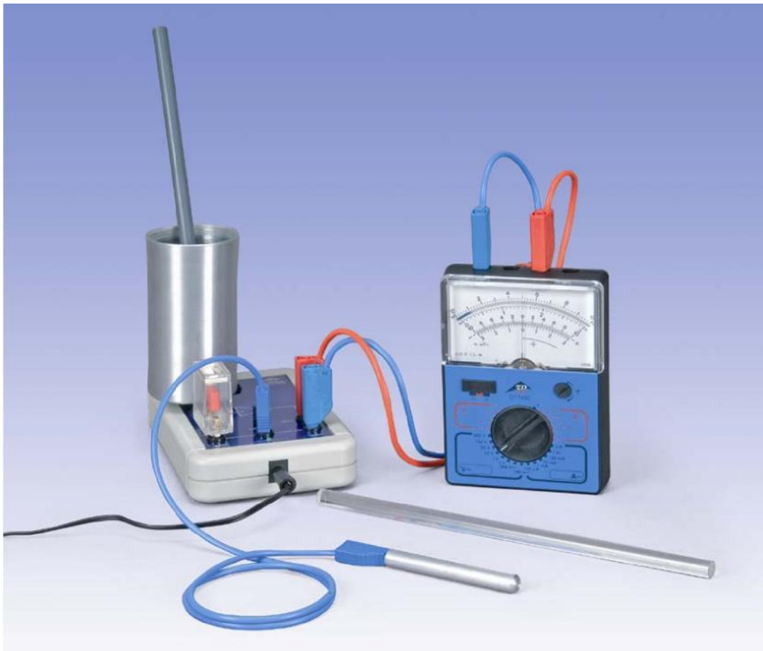
Fig. 1 Versuchsaufbau zur Messung von Ladungen in der Elektrostatik
