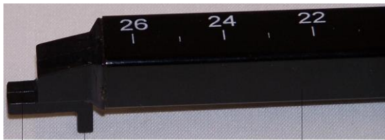
Magnetfeldsonde: 1 tangentielle Hallsonde (z-Richtung), 2 axiale Hallsonde (x-Richtung), 3 Träger
