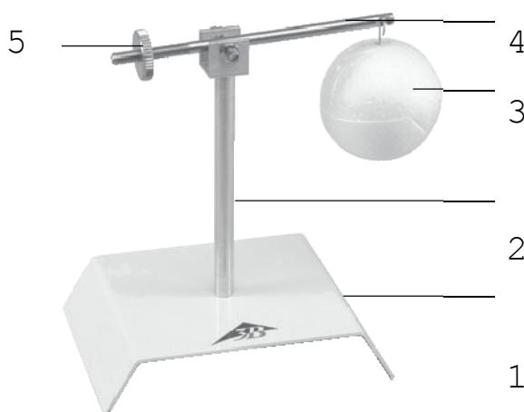
A balança de sustentação serve para a comprovação da ação da força de sustentação sobre um corpo no ar.
