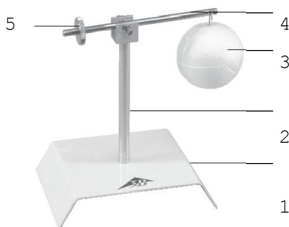
La balanza sirve para la comprobación del empuje ascensional de un cuerpo frente a la presión atmosférica.
