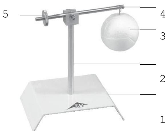
Cette balance permet de démontrer la poussée verticale sur un corps dans l'air.
