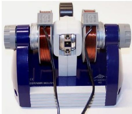
Fig. 6 Basiseinheit mit Permanentmagnet und Spulen komplettiert
