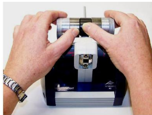
Fig. 3 Lösen des Jochs vom Permanentmagneten
