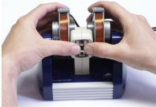
Fig. 5 Magneten auf die Montagescheiben ziehen
