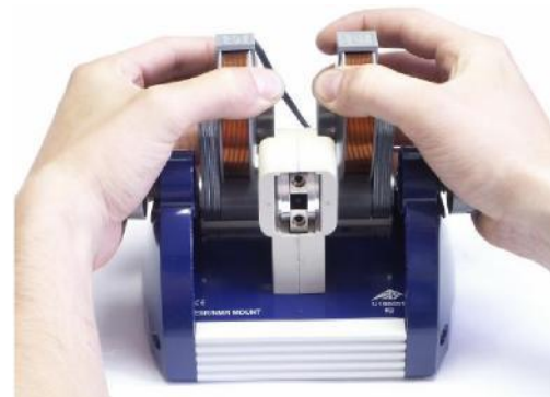
Fig. 4 Spreizen der beiden Permanentmagneten
