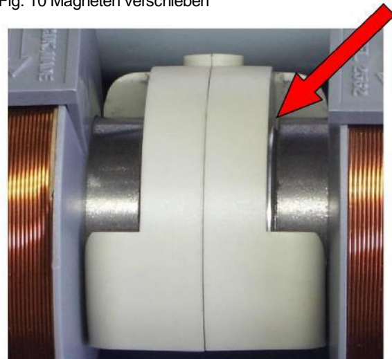
Fig. 11 Magnet aus Endlage verschoben
