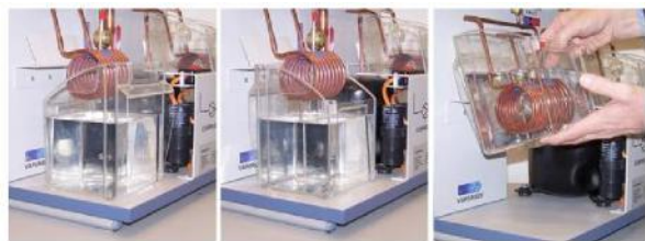
Fig. 3 Anbringen des Wasserbehälters an der Wärmepumpe Links: Wasserbehälter mit niedriger Kante zur Wärmepumpe Mitte: Wasserbehälter gedreht, mit niedriger Kante nach vorn zeigend Rechts: Wasserbehälter wird ins Halteblech eingehängt
