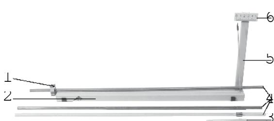
L'appareil permet de démontrer la dilatation linéaire de corps solides ainsi que de déterminer le coefficient de dilatation du cuivre, du fer et du verre.
