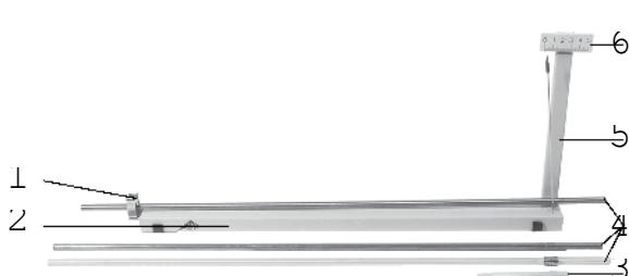
Este aparato se utiliza para determinar la dilatación de cuerpos sólidos así como para establecer el coeficiente de dilatación del hierro, latón y vidrio.
