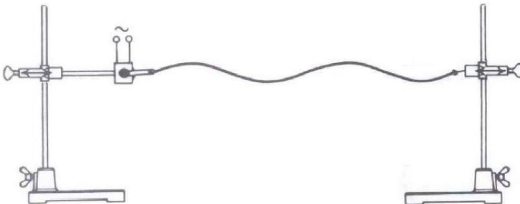
Fig. 2 Anregung von Transversalwellen in einem Gummiband unter Verwendung eines Sinusgenerators
