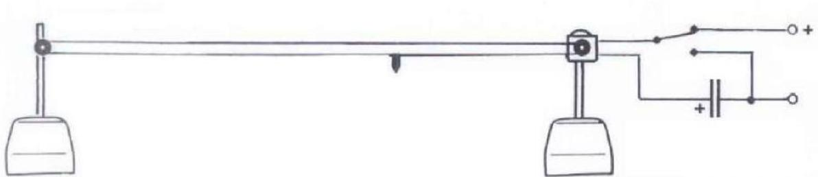
Fig. 5 Energie in einem Kondensator (zugeführte Energie gleich abgegebener Energie)
