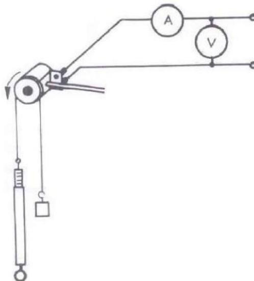
Fig.4 Bestimmung des Wirkungsgrads des Motors
