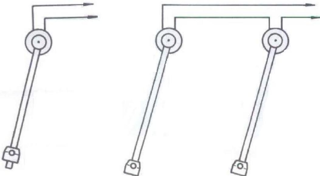
Fig. 7 Aufzeichnung mechanischer Schwingungen mit einem XY-Schreiber: eines Stabpendels (links) Überlagerung gleichfrequenter Schwingungen (rechts)
