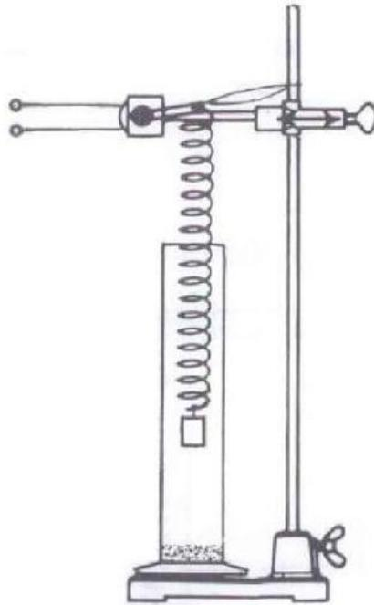
Fig. 6 Erzwungene Schwingungen eines Federpendels
