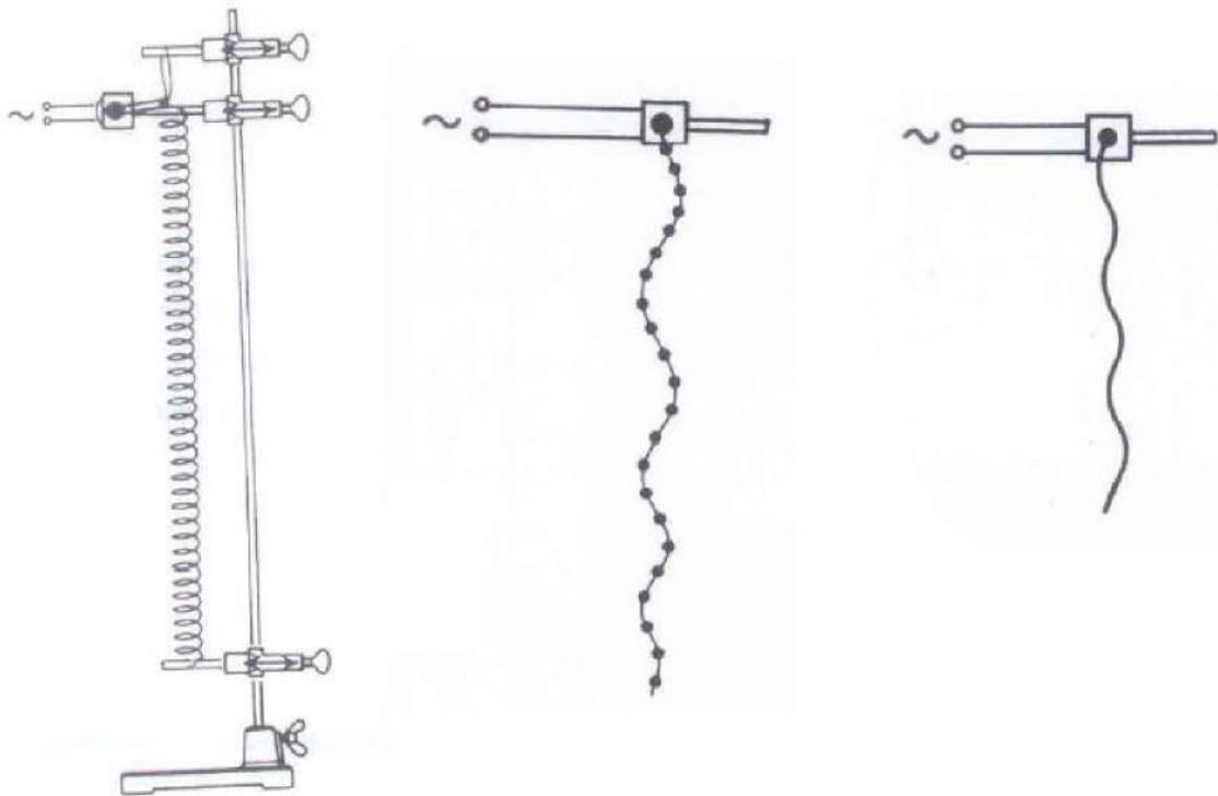
Fig. 3 Anregung von Longitudinalwellen in einer Schraubenfeder (links) Anregung von Transversalwellen in einer hängenden Kette (Mitte) und einer Blattfeder(rechts) unter Verwendung eines Sinusgenerators
